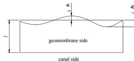
Fig. 3. Geomembrane width changes on upper edge
